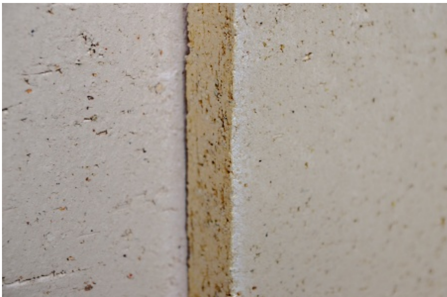
Lisované šamotové tvarovky
