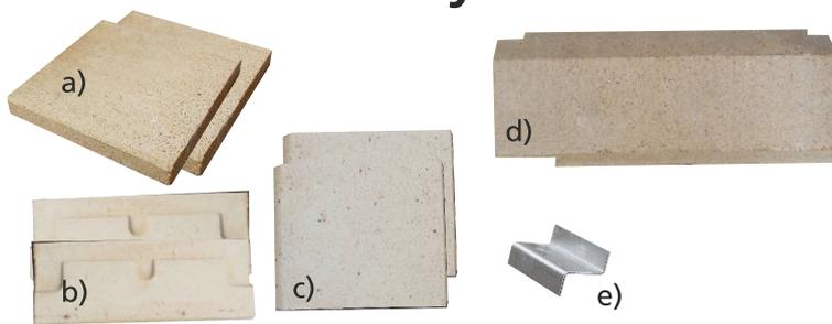
Do vybraného a vyčištěného korpusu kamen dáme dvě šamotové tvarovky 235x210x30 (obr. a), do krajů vložíme tvarovku (obr. c) se skosenou hranou. Tvarovka spodní boční přední s výřezy (obr. b) umístíme na boky korpusu kamen. Mezi ně se vsune šamotová tvarovka nad popelníková dvířka (obr. d). Na zadní šamoty umístíme plechový držák „Zetko“ (obr. e).
