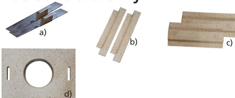
Na boční skosené tvarovky umístíme plechové prodloužené držáky (obr. a). Vedle příkládacích dvířek umístíme dvě malé tvarovky (obr. b). Do boků korpusu kamen na plechové drážky vložíme litinovou vložku s žebry. Na záda kamen vložíme tvarovky (obr. c), které po výřez zasuneme za vložku s žebry. Přišroubujeme držáky na deflektor a vložíme poslední šamotovou tvarovku s otvorem pro kouřovod (obr. d).
