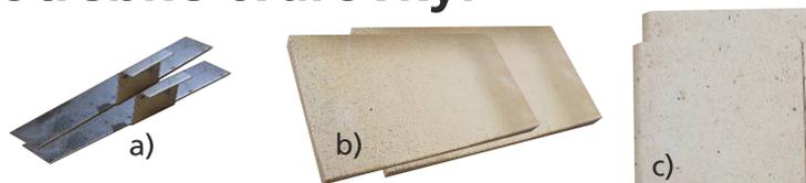
Do zadní části kamen vložíme šam. tvarovku (obr. b) 420x225x30 mm. Na boční šam. tvarovky dáme plechové držáky ve tvaru „Z“ s prodlouženou základnou, do krajů za držáky vložíme tvarovku (obr. c) se skosenou hranou - směrem nahoru. Pod příkládací dvířka vložíme šam. tvarovku o velikosti 420x225x30 mm (obr. b), mezi tuto šamotovou tvarovku a příkládací dvířka patří i těsnící šňůra (průměr D10, D12) - vyplníme TMT, M-flexi.
