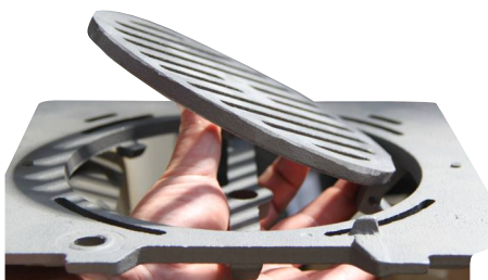
Úhel potřebného naklonění roštu
