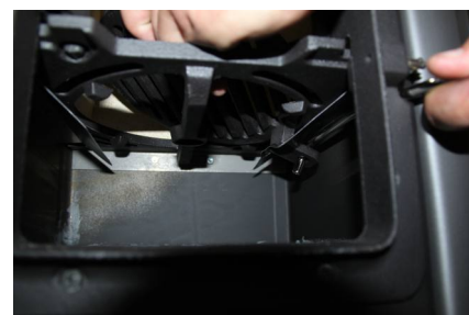
Úhel potřebného naklonění roštu v kamnech
